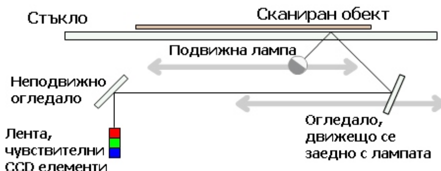
фиг.4 Принцип на действие - скенер с CCD елементи
