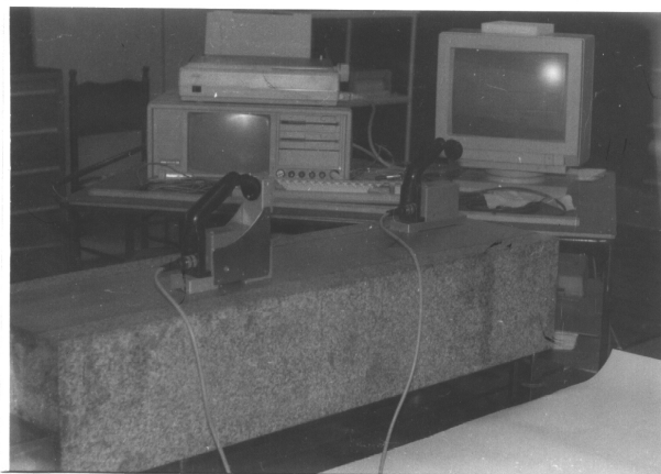
Фиг. 11.2. Електронни нивелири на фирма “Willer” за измерване на отклонение от равнинност
