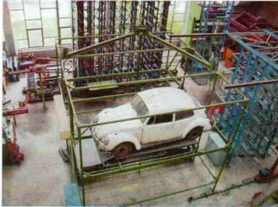
Фиг. 5 Експериментален образец на паркингова-гаражна система в Лабораторията по подвижно транспортна техника на ТУ-София
