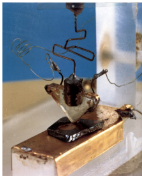
Първият транзистор (с точков контакт) AT&T Bell Laboratories
