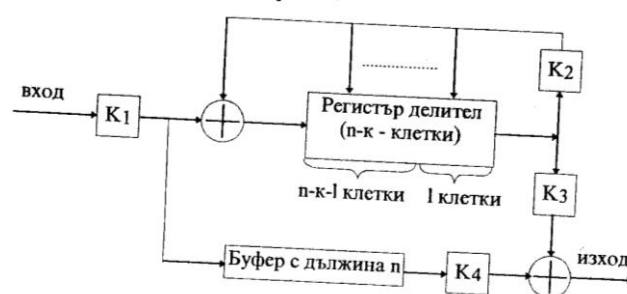
Блокова схема на декодер за корекция на единичен пакет от грешки.
