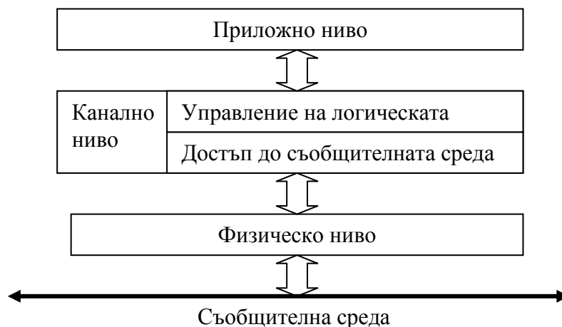
Фиг. 1: Архитектура на индустриална компютърна мрежа FIP
